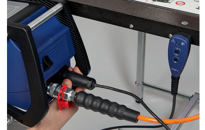
6 Fernbedienung an die Rückseite der Pumpe anschließen (drücken & drehen)
