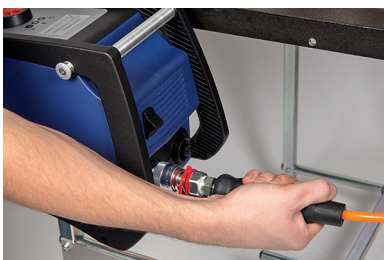
5.1 Männliche Seite der Hydraulikleitung hinten an die Pumpe anschließen
