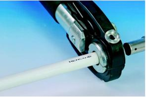
Öffnen Sie den Pressbackenkopf nach dem Verpressen und kontrollieren Sie, ob das Rohr noch bis zum Anschlag montiert ist, sodass die Sichtfenster vollständig die Farbe des Rohres angenommen haben.
